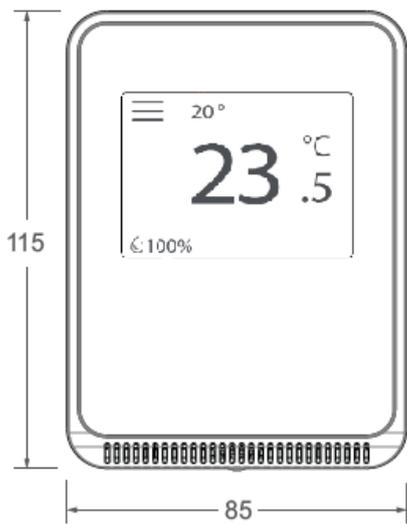
図 1. HW2 寸法図 (mm)
